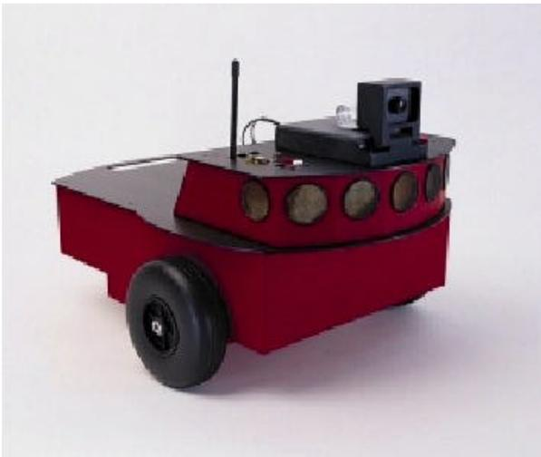
Die Pioneers haben drei oder vier Räder, wobei zwei an der starren nicht lenkbaren Vorderachse befestigt sind, gesteuert wird der Pioneer über die Hinterachse; eine gewisse inverse Ähnlichkeit zur Lenkachse eines normalen Pkws ist nicht von der Hand zuweisen.
