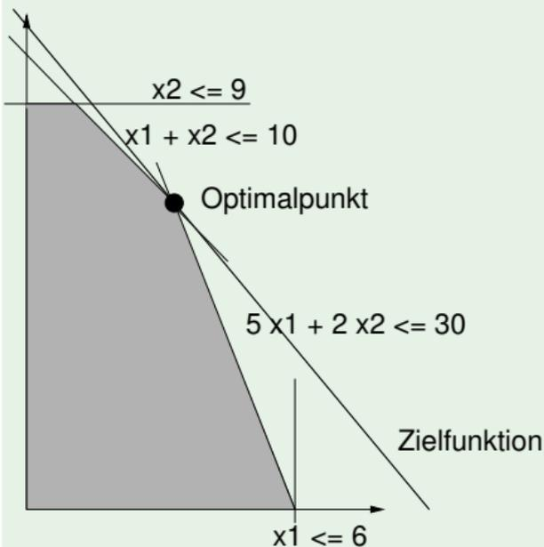
Die Zielfunktion  $z = 30x_1 + 25x_2$  wird ebenfalls durch eine Gerade dargestellt.
