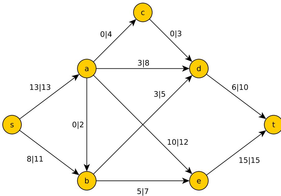
Der zunehmende Weg  $(s, b, d, t)$  ermöglicht eine Flusserhöhung um 2, also  $\Phi(f) = 23$ .
