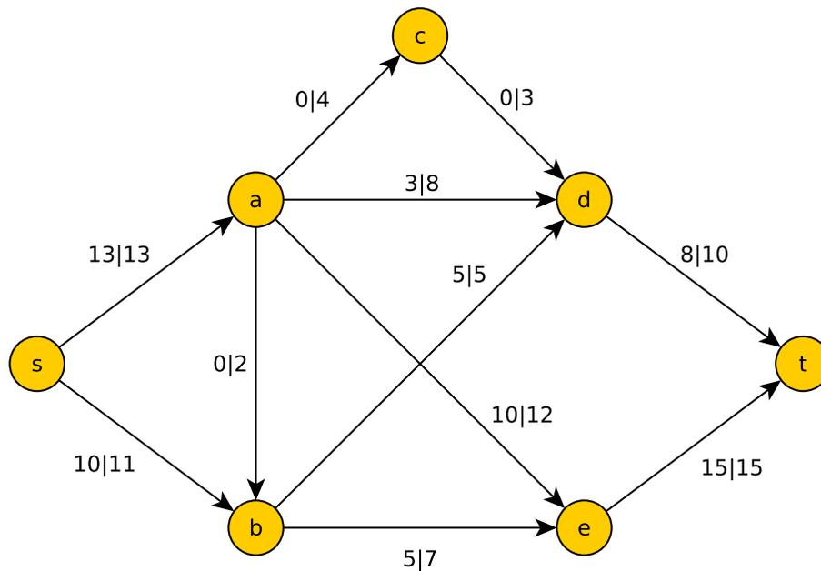
Der zunehmende Weg  $(s, b, e, a, d, t)$  ermöglicht eine Flusserhöhung um 1, also  $\Phi(f) = 24$ .
