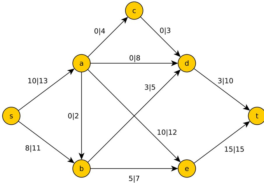
Der zunehmende Weg  $(s, a, d, t)$  ermöglicht eine Flusserhöhung um 3, also  $\Phi(f) = 21$ .
