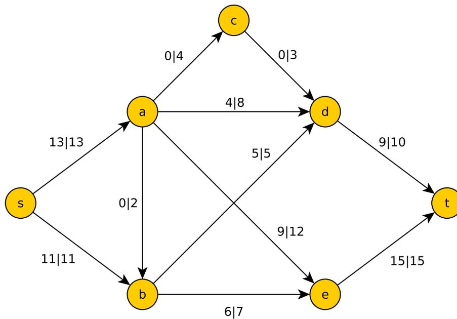
(c) Die Kantenmenge  $A = \{(s, a), (s, b)\}$  bildet einen Schnitt mit Kapazität  $c(A) = \Phi(f) = 24$ . Also ist  $f$  nach dem Max-Flow-Min-Cut-Theorem ein Maximalfluss.
