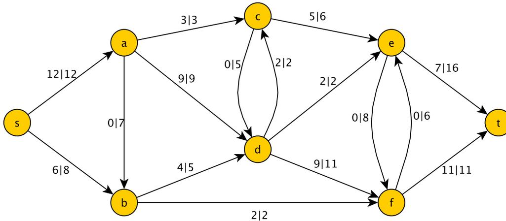
$(s, b, d, f, e, t)$  ist ein zunehmender Weg mit einer möglichen Flusserhöhung um 2. Also  $\Phi(f) = 19$ .
