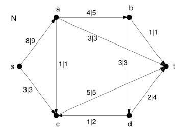
Dieser Fluss ist ein Maximalfluss, denn die Kanten (s, c), (a, c), (a, t), (b, d), (b, t) trennenden die Quelle s von der Senke t und haben eine Gesamtkapazität von 11.
