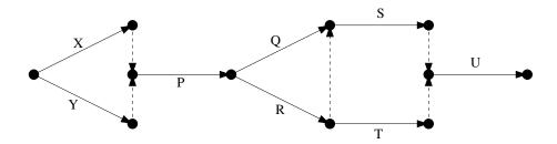
Man beachte, dass die gestrichelten Kanten sogenannte Dummy-Vorgänge darstellen, die die Dauer 0 haben. Damit hat der längste Weg (kritischer Pfad) in diesem Netzplan die Länge 5. Wir brauchen also fünf Zeiteinheiten zur Ausführung der Jobs.
