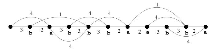
Jeder Weg von 0 nach 10 legt eine Codierung fest. Somit erhält man eine Codierung mit minimaler Gesamtlänge durch einen kürzesten Weg von 0 nach 10. Dieser kann mit dem Algorithmus von Dijkstra oder durch die Rekursionformel gemäß Satz 4.22 bestimmt werden. Für die Rekursionsformel erhalten wir:
