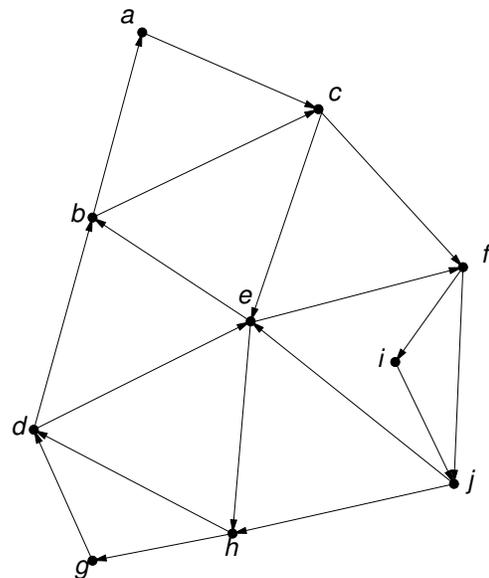
**Lösung:** Der linke Graph ist zusammenhängend und hat genau zwei Knoten mit ungeradem Grad (Knoten  $b$  und  $g$ ). Damit ist er nicht eulersch, enthält aber einen eulerschen Weg. Solch ein eulerscher Weg beginnt bzw. endet in den Knoten mit ungeradem Grad, also  $b$  und  $g$ .
